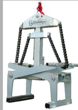
Pour le transport et la pose sûr et fiable d'éléments en béton préfabriqués, de pierres de bordure et d'autres éléments semblables. Pince mécanique à usage universel à grand angle d'ouverture et commutation entièrement automatique de l'état plein à l'état vide. Patins en caoutchouc interchangeables. Système d'automatisme « ouvert – fermé ».
