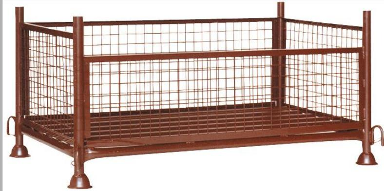
Manutentionnables à la grue et au chariot-élévateur. Construction tubulaire robuste avec quatre crochets de grue, un cadre grillagé soudé de 50/50/5 et un fond en tôle à ondes trapézoïdales.
