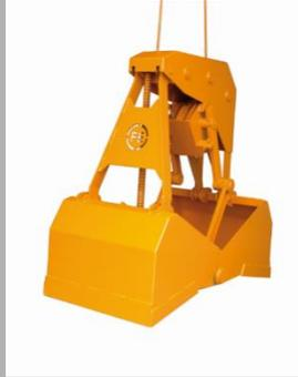
Avec la benne preneuse monocâble et bras pivotant, un grutier peut charger et décharger des matériaux, tels que: terre, gravats, sable, déblais, etc .. L'ouverture et la fermeture de la benne se fait progressivement grâce à son mécanisme à câble et bras pivotant combiné. Robustesse, stabilité, sécurité et simplicité d'utilisation caractérisent ce matériel.
