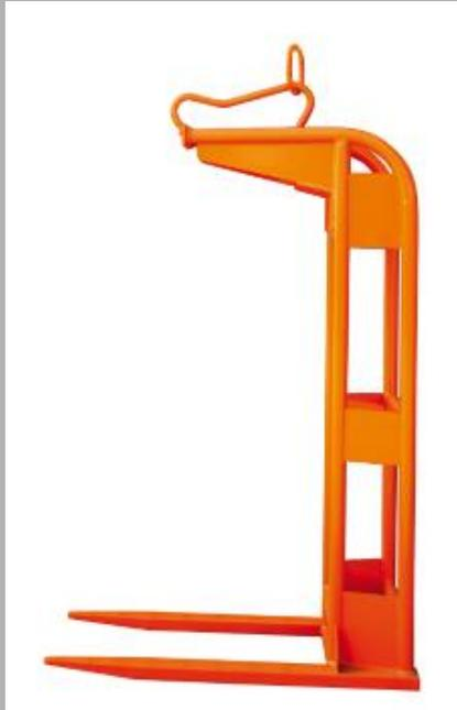
Avec écartement fixe des fourches et portée verticale utile prédéfinie. L'équilibrage du poids se fait soit automatiquement par ressort, soit par le positionnement individuel de l'anneau porteur à deux positions. Attention: le centre de gravité de la charge ne doit être en aucun cas supérieur à la mi-longueur des fourches.
