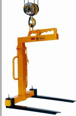
Ecartement réglable manuellement en continu de 450 à 950 mm, hauteur utile réglable par cheville enfichable de 1150 à 1750 mm, équilibrage de poids effectué par le positionnement manuel de l'anneau de levage.
