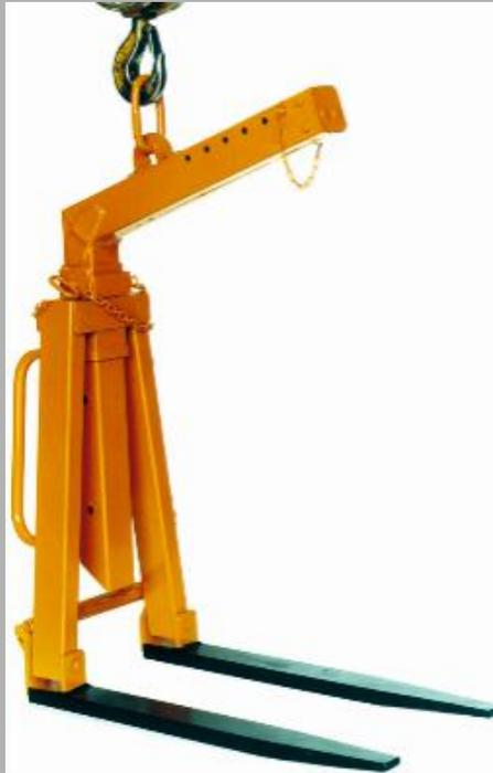
Ecartement réglable en continu par guidage de broche de 540 à 900 mm et hauteur utile réglable par cheville enfichable de 1150 à 1750 mm. Système d'auto-équilibrage du poids. Disponible avec chaîne de sécurité ou protecteur de sécurité. Modification des tailles sur demande. Attention: Le centre de gravité de la charge ne doit être en aucun cas supérieur à la milongueur des fourches.
