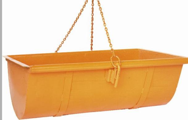
La forme avant de la benne arrondie, tend à pencher vers l'avant quand elle est au sol. Pour la vider par l'avant, décrocher la chaîne avant du crochet de sécurité, puis lever l'ensemble.
